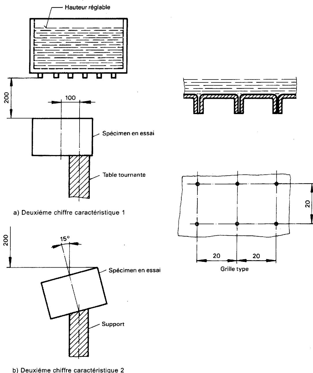
**Figure 3 – Appareil pour la vérification de la protection contre les gouttes d'eau tombant verticalement (boîte à gouttes).**
