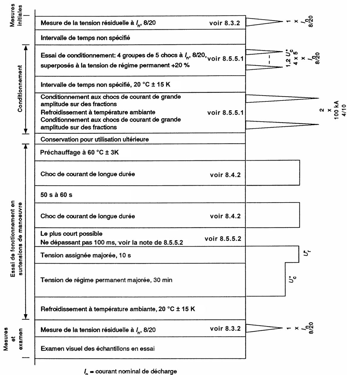
Figure 2 – Essai de fonctionnement sur les parafoudres 10 000 A, classes de décharge de ligne 2 et 3 et les parafoudres 20 000 A, classes de décharge de ligne 4 et 5 (voir 8.5.5)
