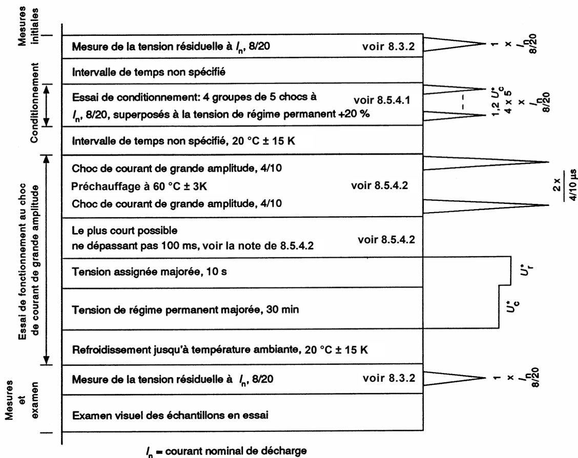
Figure 1 – Essai de fonctionnement sur les parafoudres 10 000 A, classe de décharge de ligne 1 et les parafoudres 5 000 A, 2 500 A et 1 500 A (voir 8.5.4)
