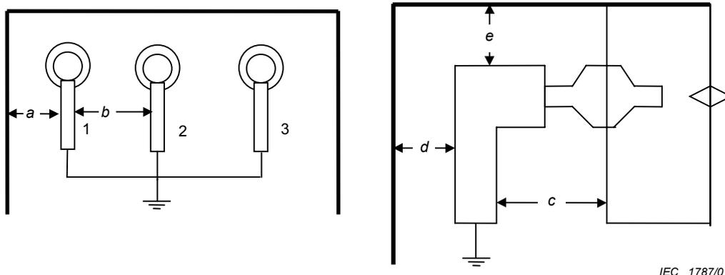
**Figure 11 – Tensions d'essai de tenue de l'isolation des parafoudres pour prise ou débroschables avec enveloppe blindée**
