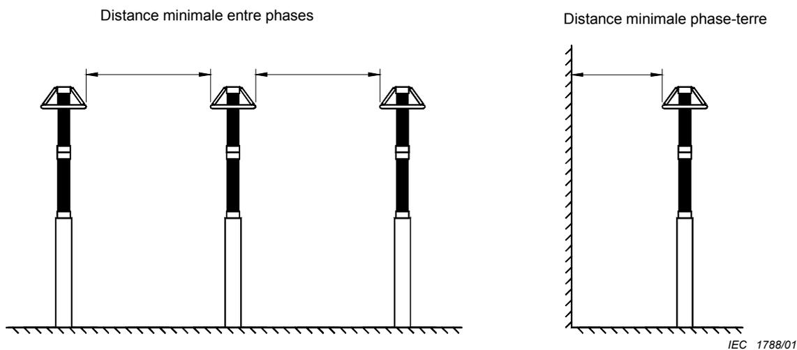
Figure L.1 – Installation triphasée type de parafoudres
