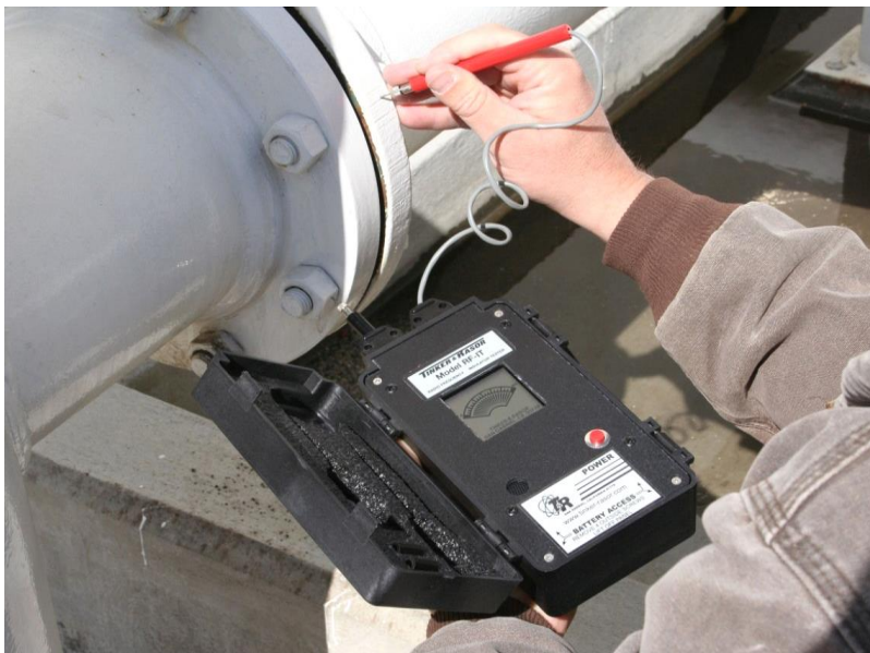
شکل ۱۳-۱۲ آزمون اتصال عایقی با روش RF-IT
