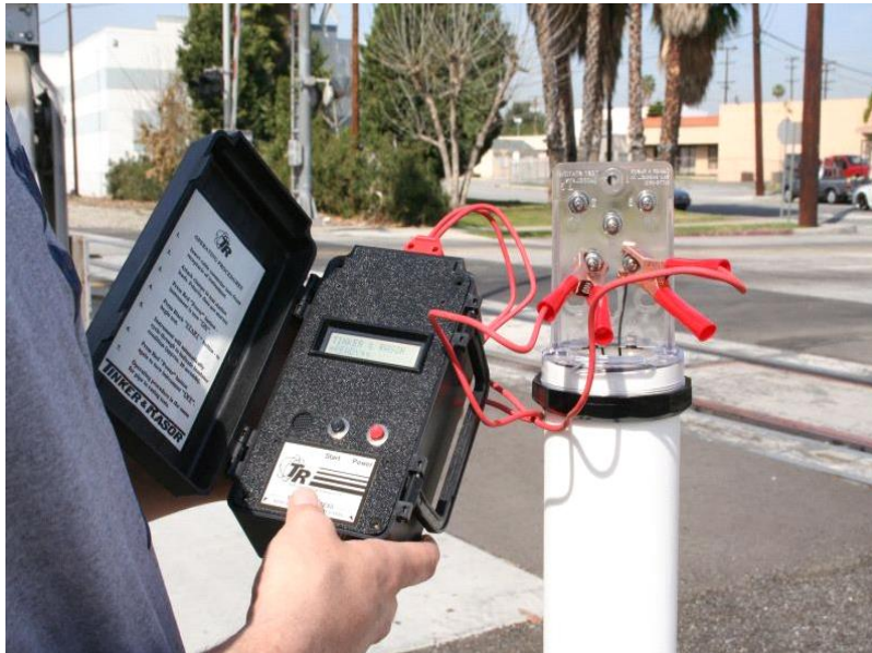
شکل ۱۲-۱۲ آزمون اتصال عایقی با روش CE-IT
