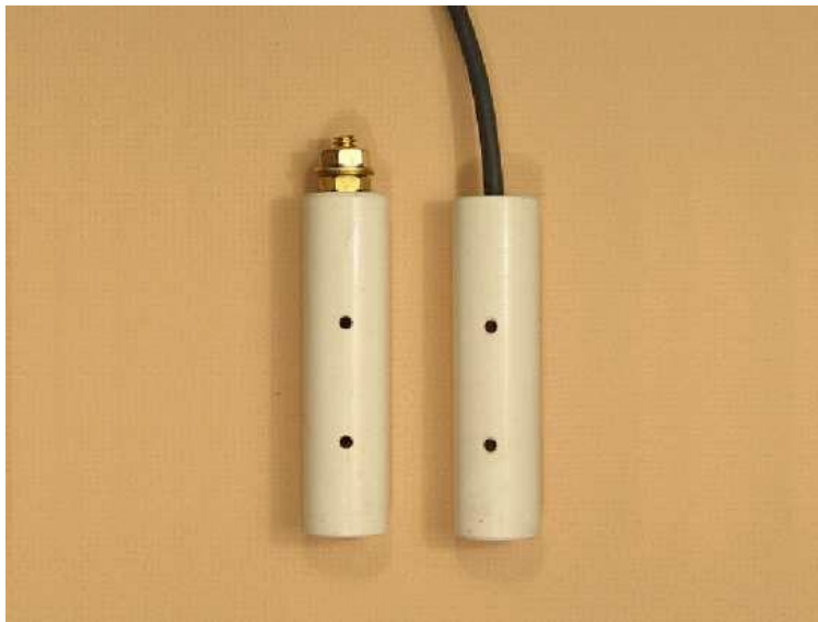
شکل ۱۲-۷ نحوه کالیبراسیون الکتروود نقره/کلرید نقره
